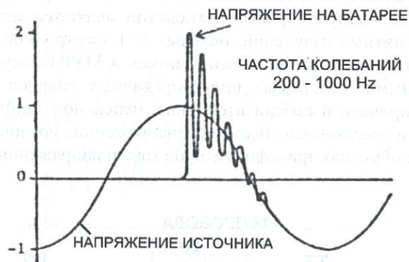
Рис. 4.9. Перенапряжения при коммутации конденсаторных батарей
