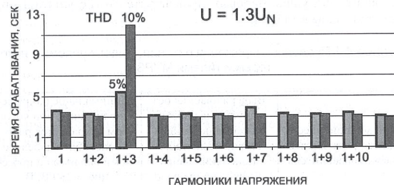
Рис. 4.29. Влияние гармоник напряжения на аналоговом входе МУРЗ на время срабатывания
