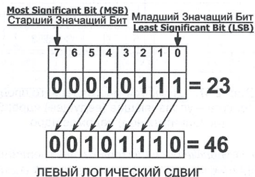
Рис.2.48 Использование сдвигателя для умножения на 2: 10111 — двоичное изображение числа 23; 101110 — двоичное изображение числа 46
