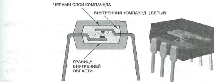
Рис. 1.50. Внутренняя конструкция оптрона
