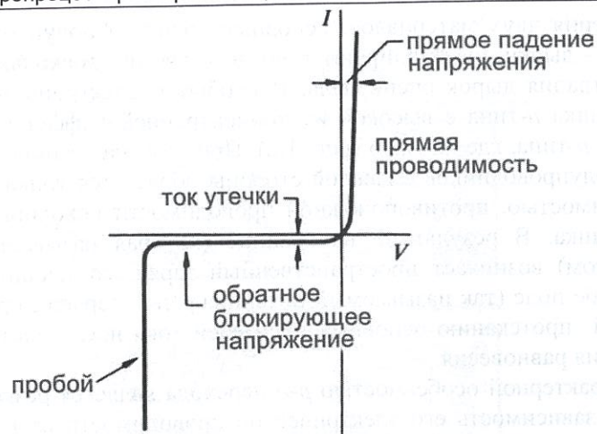
Рис. 1.3. Вольт-амперная характеристика одиночного p - n -перехода (диода)
