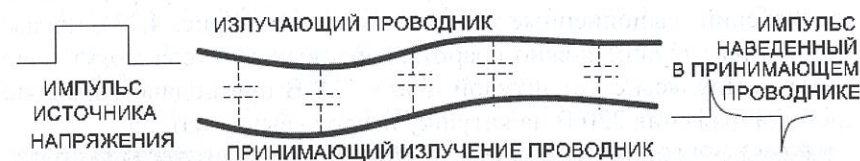
Рис. 4.12. Импульсная наводка через емкостную связь между проводниками
