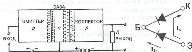
Рис. 1.5. Схема включения и принцип действия транзистора
