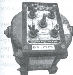
Рис. 2.66. Набор индуктивностей фирмы General Electric для проверки электромеханических реле защиты
