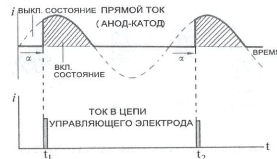
Рис. 1.43. Принцип действия тиристорного регулятора
