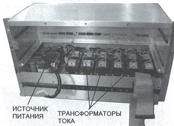
Рис. 2.7. Корпус реле SEL-487 с частично вынутыми модулями (Schweitzer Engineering Laboratories)
