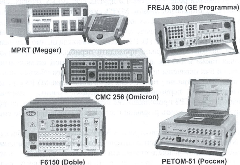
Рис. 2.68. Современные компьютеризированные тестовые системы последнего поколения для испытания многофункциональных микропроцессорных защит
